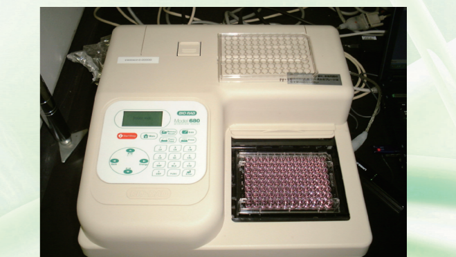
▲プレートリーダーによる、化合物活性の測定。 分泌された酵素の活性を測定することによって、化合物をスクリーニングしている。
