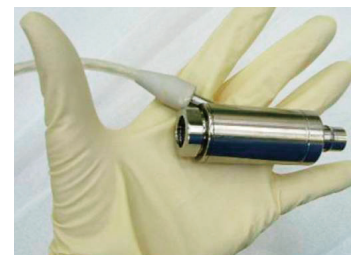
▲動圧軸受の原理により血液室内で羽根車が浮上して回転する軸流式血液ポンプ。世界最小最軽量クラスを実現。
