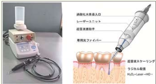
図2. 試作治療器(左)と構成要素の模式図(右)
